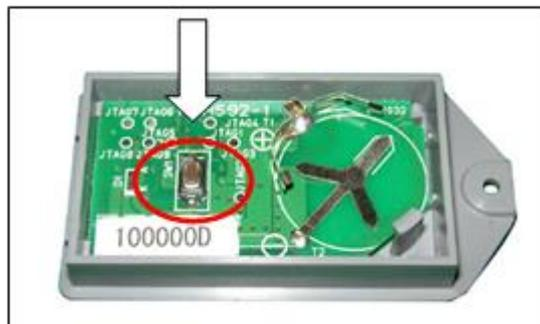
④新しい電池のプラス極が上側になるようにして、電池ホルダに差し込み、交換してください。
